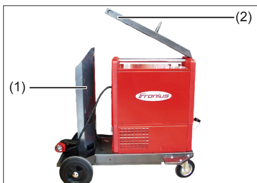
Demontaż uchwyty podajnika drutu
