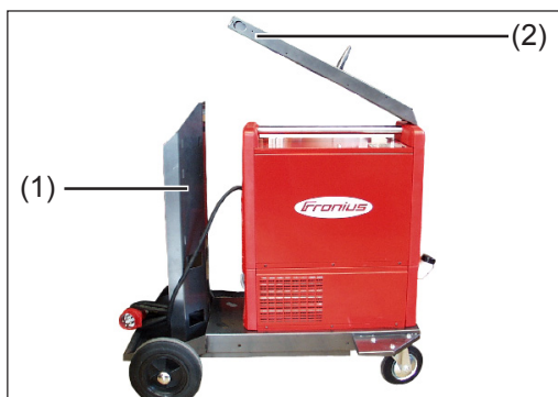
Demontáž uchycení podavače drátu
